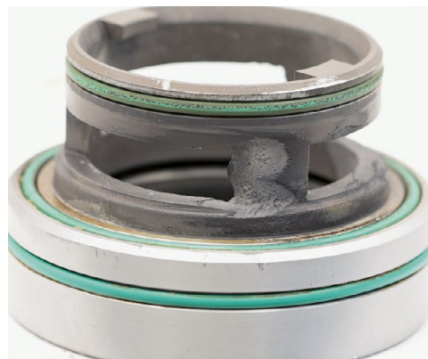
Cavitation dans le boîtier du thermostat, exemple 1
