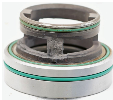
Cavitation dans le boîtier du thermostat, exemple 2
