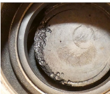
Cavitation dans le boîtier du thermostat, exemple 2
