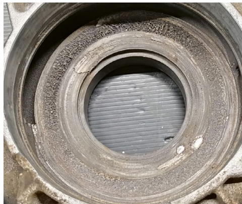
Cavitation dans le circuit de refroidissement, exemples 1-4
