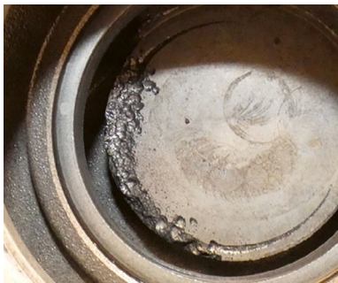
Kavitation im Thermostatgehäuse, Beispiel 2
