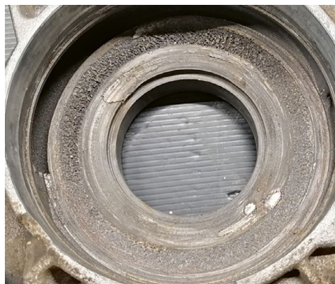
Kavitation im Kühlkreislauf, Beispiele 1–4
