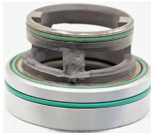
Kavitation im Thermostatgehäuse, Beispiel 2
