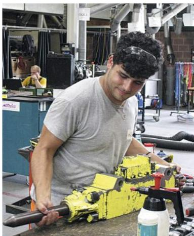
AM Suisse Ticino: Kontrolle und Montage eines Hydraulikhammers.
